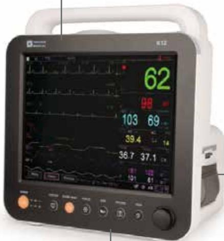
Batería de Li-Io hasta 3 horas de monitorización continua
