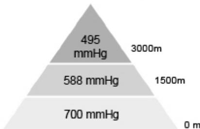
Variación de la presión según altura respecto nivel del mar, a temperatura de 22°C.
