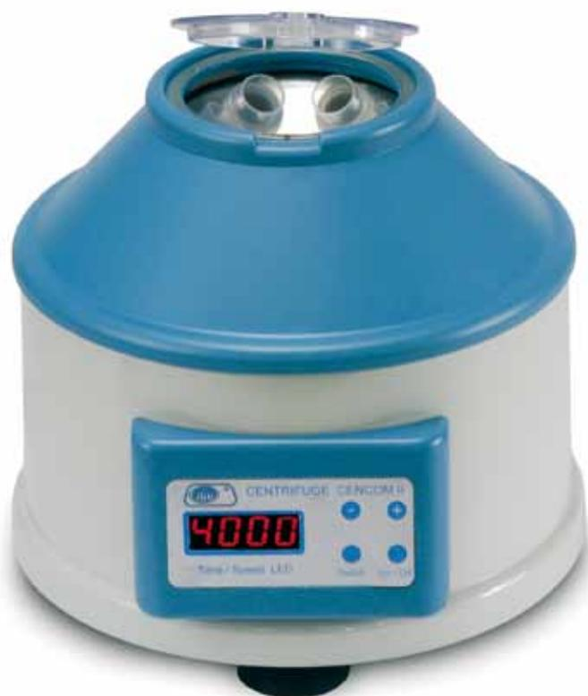
Se suministra con 6 adaptadores con 6 tubos de vidrio de 15 ml y 6 adaptadores adicionales para tubos Falcon de 15 ml.
