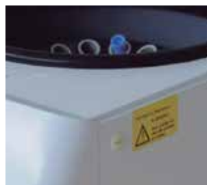
Sistema de apertura de emergencia en caso de fallo del suministro eléctrico.
