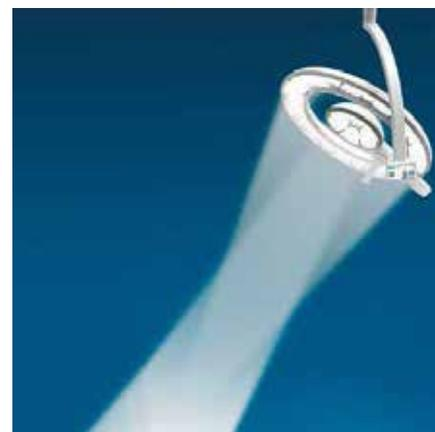
La columna de luz profunda disminuye la necesidad de ajustar la luz y así mejora la eficiencia en el funcionamiento teatros. La profundidad de iluminación L1 + L2 al 60% es 750 mm (Q-Flow 6) y 700 mm (Q-Flow 4). Al 20% el valor es 1700 mm (Q-Flow 6) y 1400 mm (Q-Flow 4).
