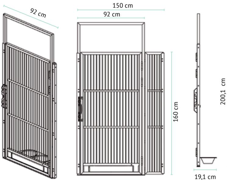
Puertas para box de hospitalización de animales. Pensadas para la seguridad de los profesionales y para el bien estar del paciente. Diseñadas con CAD 3D y mecanizadas con CNC Láser. Ofrecemos puertas autoinstalables que se pueden montar en espacios desde 92 hasta 150 cm.
